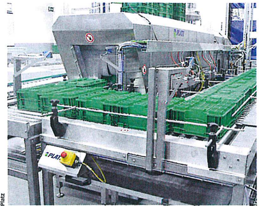
Das Bild zeigt eine KLT-Waschanlage mit automatischer Zuführung und Drehmodul. Neben KLT-Behältern können mit dieser Anlage auch E1-, E2- und E3-Behälter gereinigt werden.
